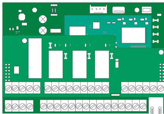
Inserire la scheda LA2PE sulla parte superiore della scheda utilizzando i portacontatti.
